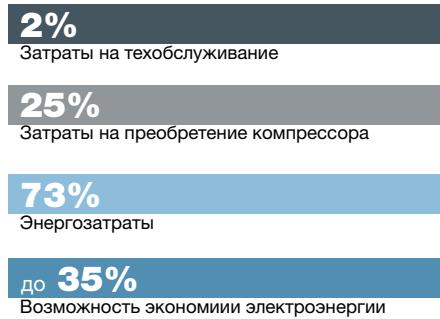
Стоимость сжатого воздуха складывается из стоимости оборудования, эксплуатационных / сервисных затрат и расходов на электроэнергию. При этом доля последних составляет более 70%. Поэтому COMARO обращает особое внимание на максимальную энергетическую эффективность своей техники и предлагает оснащение моделей блоком частотной регулировки оборотов двигателя (инвертором).
