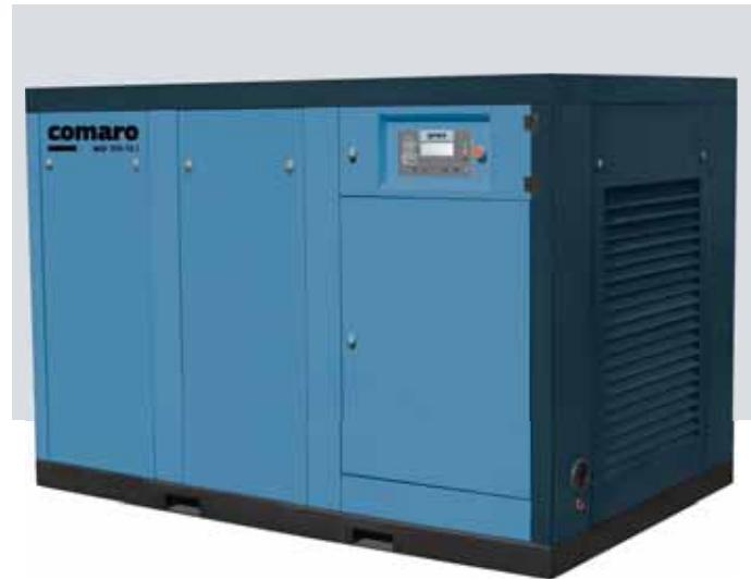
■ Для предприятий с неравномерным потреблением сжатого воздуха наиболее оптимальным выбором могут стать компрессоры серии MD с частотным преобразователем (индекс «I» в названии). За счет регулировки оборотов двигателя, через прямой привод меняются и обороты винтовой пары, что позволяет компрессору производить тот объем сжатого воздуха, который будет соответствовать профилю потребления сжатого воздуха на производстве. Использование компрессоров серии MD с частотным преобразователем, позволяет:
