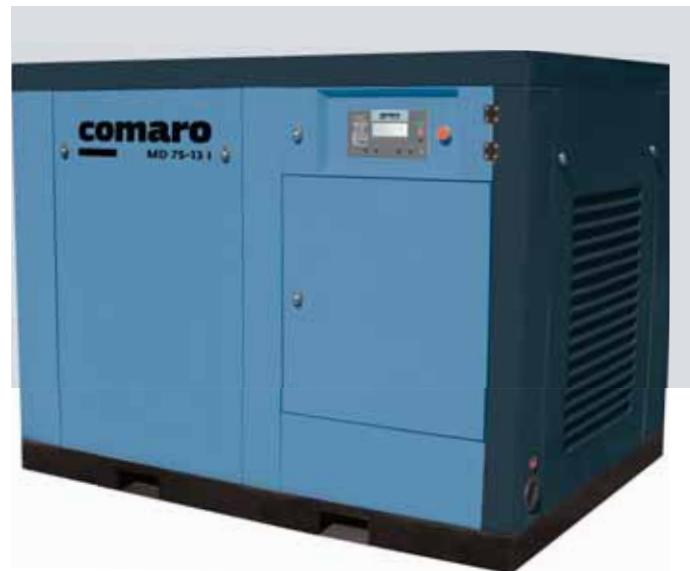
■ Атрибутом современных винтовых компрессоров высокой мощности является наличие прямого привода. КПД данного привода составляет 99,95%, что выше, чем у традиционных способов передачи. Эффективная передача крутящего момента, отсутствие дополнительных частей, которые могут выйти из строя или разрушить сопряженные агрегаты, - все это делает компрессоры серии MD более надежными и легкими в обслуживании. Для таких компрессоров характерны:
